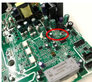
3. Vérifiez l'alimentation électrique du module d'inverseur du compresseur, port CN211 sur le circuit imprimé du filtre ; la tension normale devrait être 310 V CC. Vérifiez le pont monophasé et le fusible sur le circuit imprimé du filtre. Vérifiez le câble de connexion entre le port CN4 du PCB principal de l'UE et le port CN8 du circuit imprimé du filtre, qui est le port de commande d'alimentation 12 V CC.
