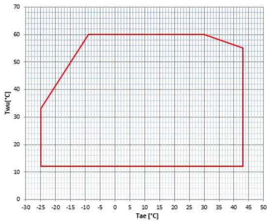
Twu [°C] = Température de l'eau à la sortie de l'échangeur
