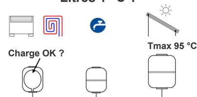
Le vase d'expansion doit être dimensionné en fonction du contenu d'eau de l'installation.
