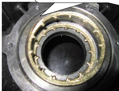
Le filtre est bloqué par des impuretés, l'aspiration du compresseur sera anormale
