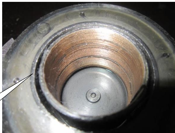
Le pignon est usé.
