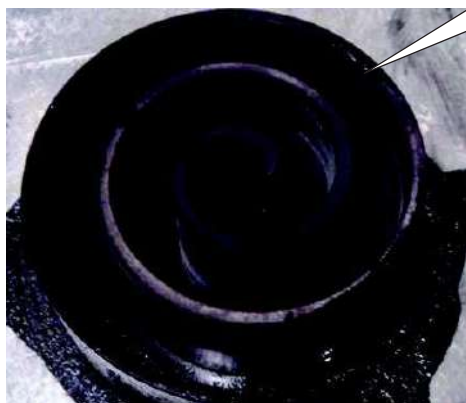
Un roulement normal de compresseur
