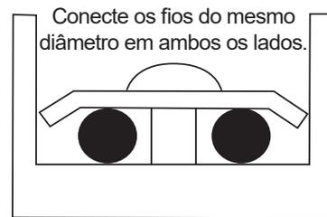
**D** Não pressione os cabos de alimentação do mesmo diâmetro de fio no mesmo lado do terminal. Não utilize dois cabos de alimentação com diâmetros de fio diferentes para os mesmos blocos de terminais; caso contrário, eles podem soltar-se facilmente devido à pressão desigual e causar acidentes, conforme mostrado na imagem abaixo.
