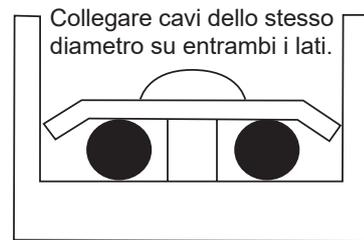
**D** Non premere i cavi di alimentazione dello stesso diametro sullo stesso lato del terminale. Non utilizzare due cavi di alimentazione di diametro diverso per la stessa morsettieria, poiché potrebbero allentarsi facilmente a causa di una pressione non uniforme e causare incidenti, come mostrato nella figura seguente.
