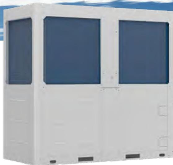
Kaysun amplia la gamma Aquantia HT con 3 nuove taglie da 50 a 70 kW. Pompe di calore monoblocco full inverter raffreddate ad aria con gas refrigerante naturale R290. Progettate per garantire il funzionamento a basse temperature esterne, alte efficienze e con temperature di mandata fino a 85°C. Ideali per la sostituzione o l'ibridazione con le caldaie.
