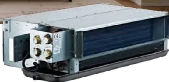
Queste unità canalizzate sono dotate di un evaporatore inclinato che favorisce una maggiore area di scambio, con un'altezza compatta e ridotta che facilita l'installazione in locali con controsoffitti di appena 241 mm. I collegamenti del modello standard si trovano alla sinistra della mandata.
