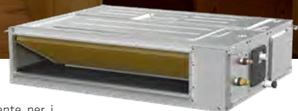
La gamma di canalizzati di Kaysun è una soluzione eccellente per i luoghi in cui è necessario suddividere l'aria in modo equilibrato. Regola automaticamente la pressione statica e può essere installata in verticale per adattarsi a qualsiasi luogo.
