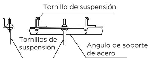
2. Instale y coloque las tuberías y los cables una vez que haya terminado de instalar el cuerpo principal. Al elegir por dónde empezar, determine la dirección de las tuberías que se van a sacar. Especialmente en los casos en los que haya un techo de por medio, alinee las tuberías de refrigerante, las tuberías de desagüe y las tuberías interiores y exteriores con sus puntos de conexión antes de montar la unidad.
