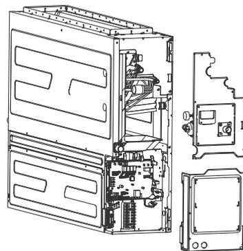
3. Retire los 4 tornillos, gire los componentes de la bomba de agua 90° y fíjelos de nuevo a la placa de montaje de la bomba de agua.
