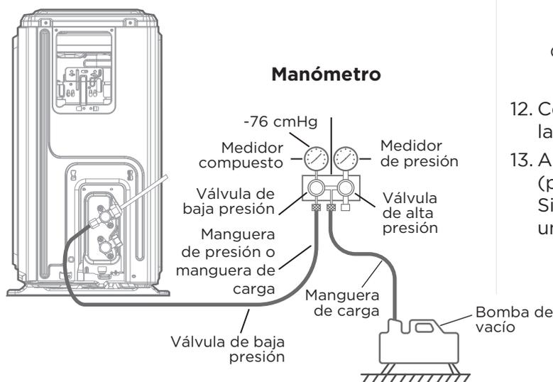
6. Cierre el lado de baja presión del manómetro y apague la bomba de vacío.
