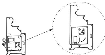
4. Instale los componentes de la bomba en la máquina y conecte el juego de cables.
