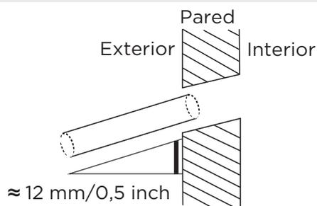
El tubo de desagüe sirve para evacuar el agua de la unidad. Una instalación incorrecta puede causar daños a la unidad y a la propiedad.
