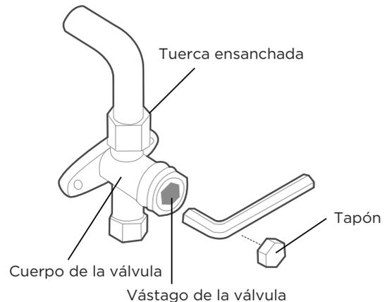
12. Con una llave hexagonal, abra completamente las válvulas de alta y baja presión.
