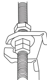
9. Monte la unidad interior en los pernos de suspensión con un bloque. Coloque la unidad interior plana utilizando un indicador de nivel para evitar fugas.
