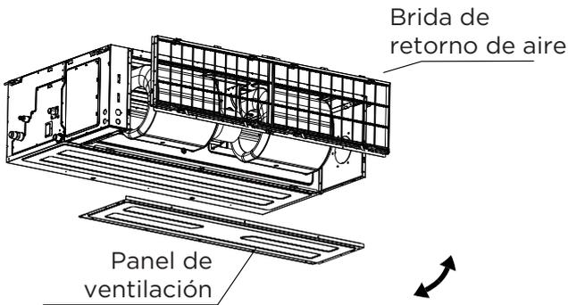
2. Cambie las posiciones de montaje del panel de ventilación y de la brida de retorno de aire.
