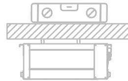
El techo es horizontal y su estructura puede soportar el peso de la unidad interior.
