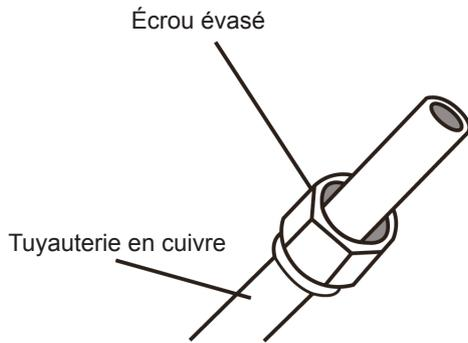
4. Retirer le ruban de PVC des extrémités de la tuyauterie avant d'effectuer les travaux d'évasage.
