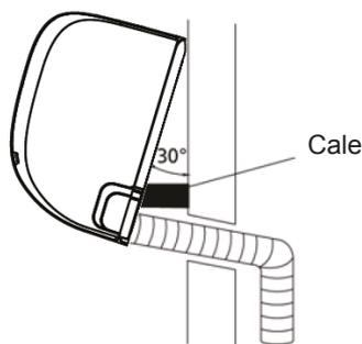
3. Connecter le flexible de vidange et les tuyauteries de réfrigérant (se reporter à la section Connexion de la tuyauterie de réfrigérant de ce manuel pour les instructions).
