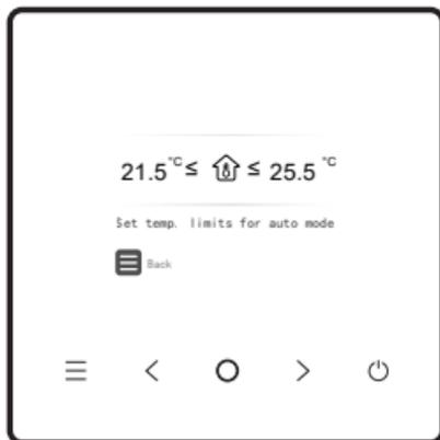
Le réglage de la température en mode automatique vous permet de régler la température en mode refroidissement/chauffage automatique et de maintenir la température intérieure dans la plage définie.
