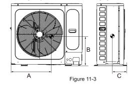
Table 11-1 Unit: mm Model В С А 8-10kW 506 413 110 12kW 551 420 63.5 14-16kW 580 410 99.2
