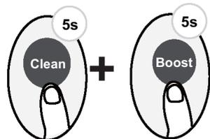
Drücken Sie die Tasten **Clean** und **Boost** gleichzeitig länger als 5 Sekunden, um die Sperrfunktion zu aktivieren. Keine der Tasten reagiert, es sei denn, Sie drücken diese beiden Tasten erneut für zwei Sekunden, um die Sperre aufzuheben.
