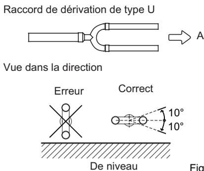
Les raccords de dérivation existent en différents diamètres de tuyaux, pouvant être facilement adaptés à différents diamètres de tuyaux. Lorsque vous raccordez des tuyaux, sélectionnez la section de tuyau ayant le diamètre approprié, coupez-la par le milieu à l'aide d'un coupe-tube et éliminez les ébarbures, comme le montre la figure ci-dessous.
