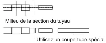
La longueur de la section droite du tuyau entre les tuyaux de dérivation continus ne doit pas être inférieure à 500 mm. La section droite du tuyau situé derrière l'extrémité du tuyau de dérivation ne doit pas être inférieure à 500 mm. La longueur du tuyau droit entre deux coudes à angle droit ne doit pas être inférieure à 500 mm.
