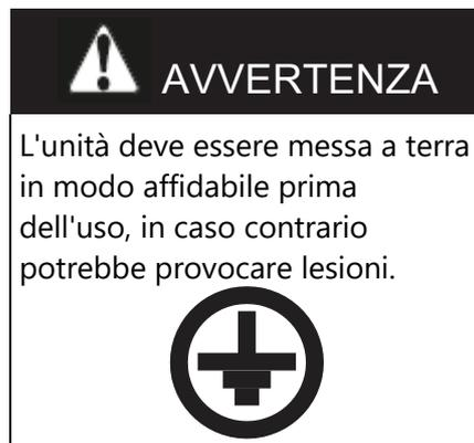
Qualora non sia possibile assicurarsi che l'alimentazione domestica sia ben collegata a terra, non installare l'unità. Affidare il collegamento a terra e l'installazione dell'apparecchio a personale qualificato, come ad esempio idraulici certificati, personale autorizzato di aziende elettriche e di assistenza abilitato.
