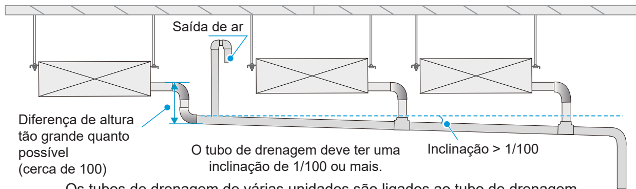
Método para ligar o tubo de drenagem para uma unidade individual
