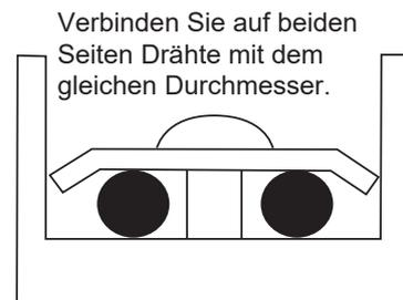
**D** Drücken Sie die Stromkabel mit demselben Drahtdurchmesser nicht auf dieselbe Seite des Terminals. Verwenden Sie nicht zwei Stromkabel mit unterschiedlichen Drahtdurchmessern für dieselben Anschlussklemmen. Andernfalls können sie sich durch ungleichmäßigen Druck leicht lösen und Unfälle verursachen, wie in der Abbildung unten dargestellt.
