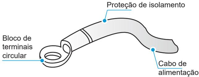
**C** Se não for possível cravar o bloco de terminais circular isolado devido a limitações no local, conecte os cabos de alimentação de mesmo diâmetro em ambos os lados do bloco de terminais da fonte de alimentação da UDI, conforme mostrado na figura abaixo.
