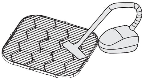
Limpe o filtro com água limpa (exceto o módulo de carvão ativado), com o lado da entrada de ar do filtro voltado para baixo.
