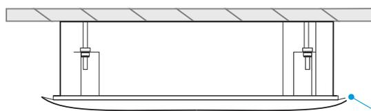
Sem apoio do teto, apertar demasiado os parafusos deformará o painel.
