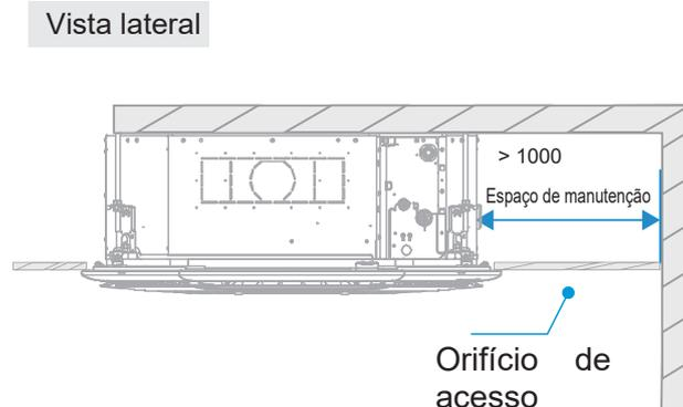
Determine as posições da abertura do teto, da unidade e dos parafusos de içamento.
