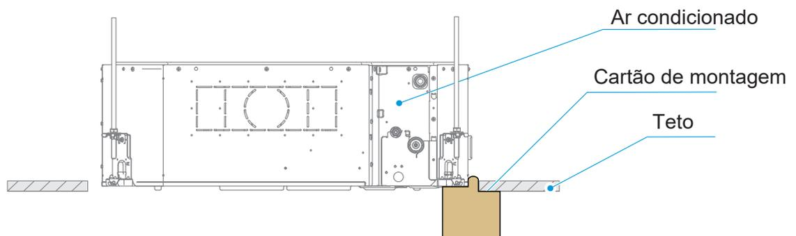
O cartão de montagem é utilizado para ajustar a distância entre o ar condicionado e o teto para garantir que o painel encaixa perfeitamente no teto após a instalação.
