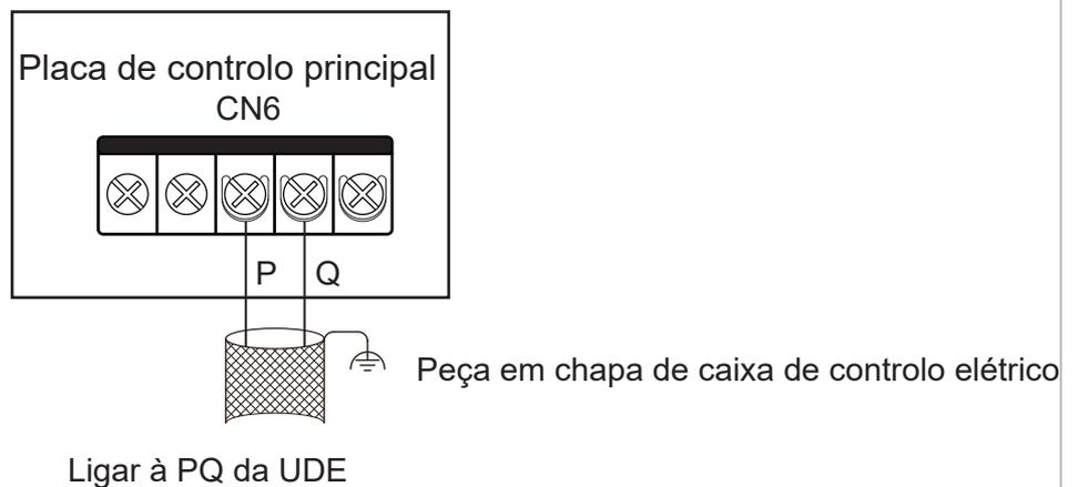
Sistema: o comprimento total máximo do cabo de comunicação P/Q entre a UDI e a UDE pode ser até 1200 m, podendo ser ligado em série, conforme figura abaixo:
