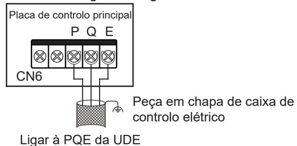
Sistema: O comprimento total máximo do cabo de comunicação P/Q/E da unidade interna e unidade externa pode ser de até 1200 m, e pode ser conectado em série conforme figura abaixo:
