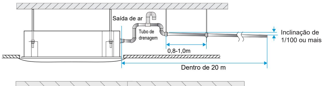
5 A extremidade do tubo de drenagem deve estar a mais de 50 mm acima do solo ou da base da ranhura de descarga de água. Além disso, não o mergulhe na água. Para descarregar a água condensada diretamente para uma vala, o tubo de descarga de água deve dobrar para cima para formar um selo de água em forma de U para impedir a entrada de odores na sala através do tubo de descarga de água.
