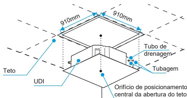
Determine a localização dos parafusos de içamento de acordo com o orifício do parafuso de içamento nos quatro cantos do cartão de montagem.
