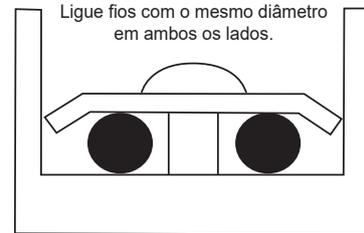
**D** Não pressione os cabos de alimentação com o mesmo diâmetro de fio no mesmo lado do terminal. Não utilize dois cabos de alimentação de diâmetros de fios diferentes para os mesmos blocos de terminais; caso contrário, eles podem soltar-se facilmente devido à pressão irregular e causar acidentes, conforme mostrado na figura abaixo.
