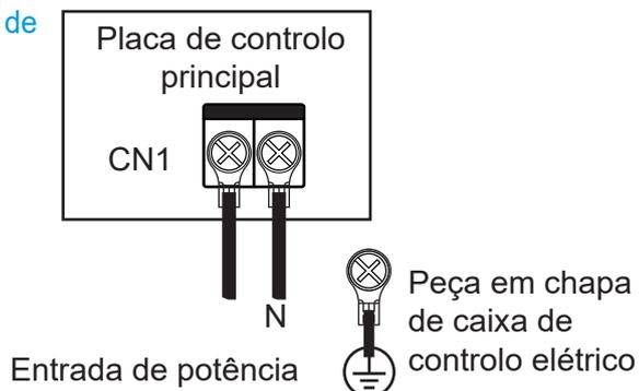
**A** Não cole e ligue o cabo de alimentação. Colar e ligar o cabo de alimentação pode causar aquecimento, resultando em incêndio.
