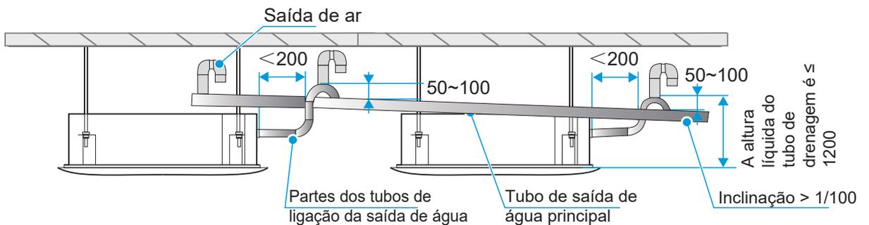
Os tubos de drenagem de várias unidades são ligados ao tubo de drenagem principal para serem descarregados através do tubo de esgoto.
