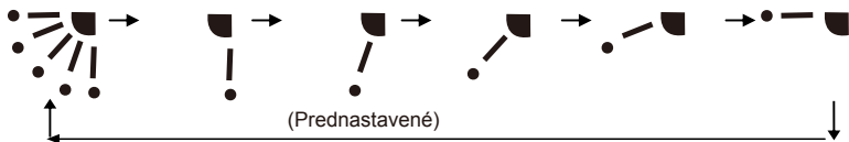
Obr. 37 – Postup nastavenia vertikálnej lamely
