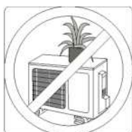
Pārliedziniet, vai nav aizsprostotas gaisa ieplūdes un izplūdes atveres
