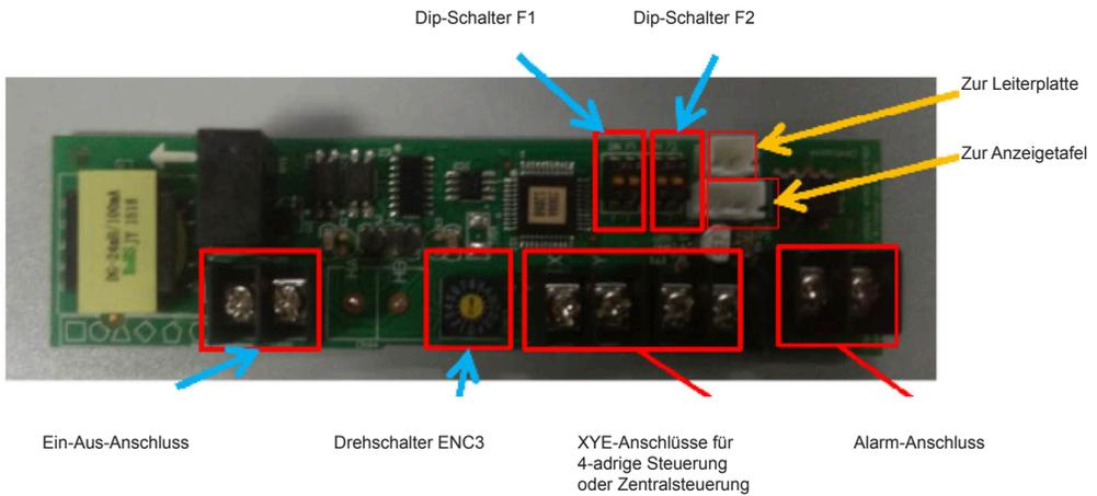
1. Der Drehschalter ENC3 und der Dip-Schalter F1 dienen zur Einstellung der Netzadresse.
