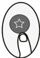
Pressionar este botão quando o controle remoto está ligado retorna automaticamente às configurações anteriores, incluindo o modo de operação, temperatura definida, nível de velocidade do ventilador e função de hibernação (se ativada).
