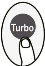
Quando você seleciona a função Turbo no modo COOL, a unidade sopra ar frio com a configuração de vento mais forte para acelerar o processo de resfriamento.
