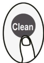
As bactérias transportadas pelo ar podem se multiplicar na unidade que se condensa ao redor do trocador de calor na unidade. Com o uso regular, a maior parte dessa umidade evapora da unidade. Pressione o botão CLEAN para limpar sua unidade automaticamente. Após a limpeza, a unidade desligará automaticamente. Pressionar o botão CLEAN no meio do ciclo cancela a operação e desliga a unidade. Você pode usar CLEAN quantas vezes quiser.
