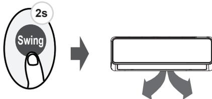
Continuez à appuyer sur ce bouton plus de 2 secondes, la fonction d'oscillation verticale des volets est activée. (selon le modèle)
