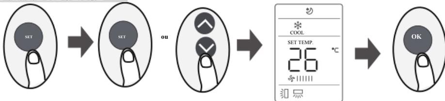
Appuyez sur le bouton SET pour entrer dans le réglage de la fonction, puis appuyez sur le bouton REGLAGE ou TEMP  $\sim$  ou TEMP  $\sim$  pour sélectionner la fonction souhaitée. Le symbole sélectionné clignote sur la zone d'affichage, appuyez sur le bouton OK pour confirmer.
