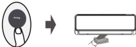
La persienne horizontale bascule automatiquement de haut en bas lorsqu'on appuie sur le bouton Balancement. Appuyez à nouveau sur le bouton pour l'arrêter.
