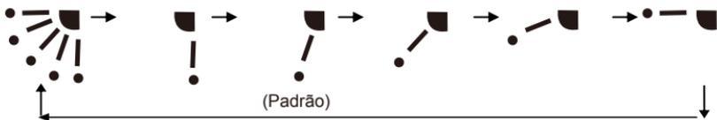
Fig. 37 - Sequência de ajuste do defletor vertical
