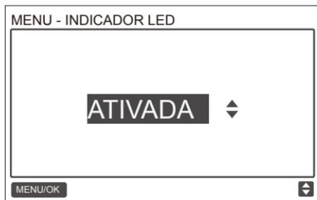
Fig. 73 - Configurar o INDICADOR LED
