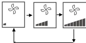
Fig. 28 A sequência de 3 velocidades do ventilador do ventilador automático HRV
