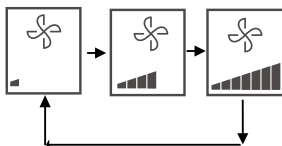
Fig. 28 Sequenza delle 3 velocità ventilatore del ventilatore automatico dell'HRV
