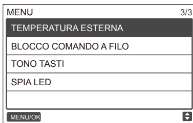
Fig. 79 - Accesso al menu TEMPERATURA ESTERNA
