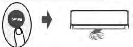
Si continua presionando el botón **BALANCEAR**, se pueden establecer 5 direcciones de flujo de aire. La rejilla puede moverse en un rango determinado cada vez que usted presione este botón. Pulse el botón hasta que alcance la dirección que desea.
