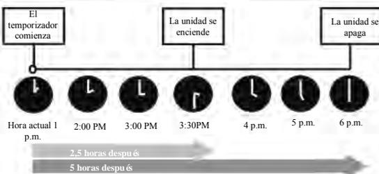
Ejemplo: Si el temporizador actual está en 1:00 PM, para ajustar el temporizador siguiendo los pasos anteriores, la unidad se encenderá en 2,5 horas más tarde (3:30PM) y se apagará a las 6:00 PM.
