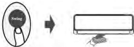
La rejilla horizontal se balanceará de arriba hacia abajo automáticamente cuando pulse el botón **BALANCEAR**. Pulse nuevamente para parar.
