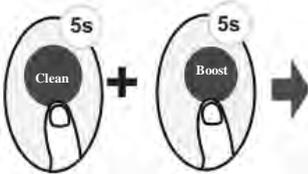
Pulse juntos los botones **LIMPIAR** y **TURBO** por más de 5 segundos para activar la función de bloqueo. Ningún botón responderá a menos que se pulsen estos dos botones durante dos segundos de nuevo para desactivar el bloqueo.
