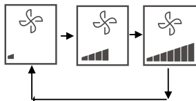
Sch. 28 La séquence des 3 vitesses de ventilation de ventilation auto de VRC
