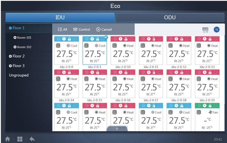
La pantalla ECO tiene dos parámetros: IDU (unidad interior) y ODU (unidad exterior).
