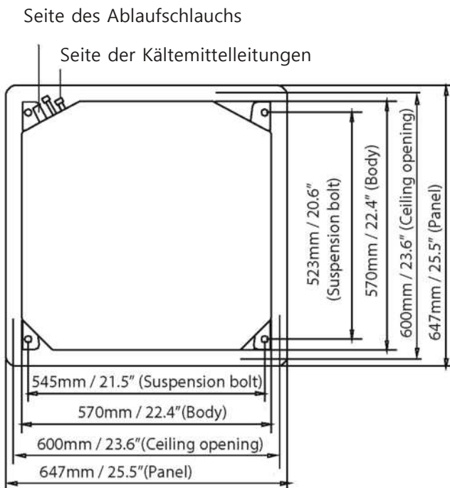
Größe des Deckenlochs für Kompaktgeräte
