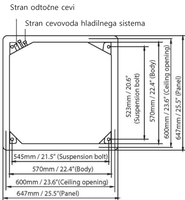
Montaža notranje enote
