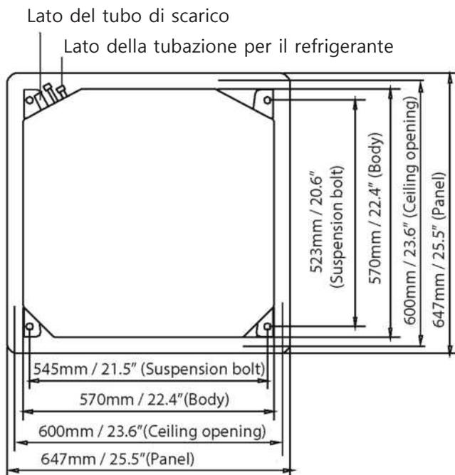
Dimensioni del foro sul soffitto per modelli compatti
