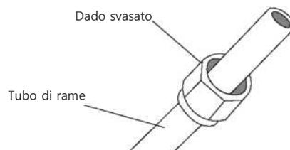
4. Rimuovere il nastro in PVC dalle estremità del tubo quando si è pronti per il lavoro di svasatura.
