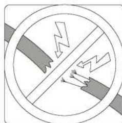
Controleer op beschadigde kabels
