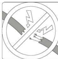
Verificați să nu existe cabluri avariate
