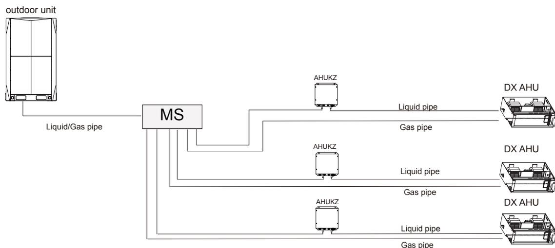
Nota: La capacità massima per ogni AHU collegata a una scatola di selezione modalità non deve essere superiore a 28 kW.
