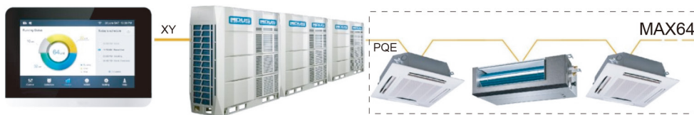
Abb. 1(a). Verkabelung des Berührbildschirms an Außengeräte.
