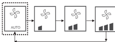
Abb. 28. Die Abfolge von drei Lüfterdrehzahlen.
