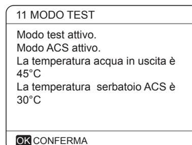
Durante l'esecuzione del test MODALITÀ ACS, la temperatura nominale predefinita dell'acqua sanitaria è di 55°C. Il TBH (Tank Boost Heater) si accende dopo che il compressore funziona per 10 minuti. Il TBH si spegnerà 3 minuti dopo, la pompa di calore funzionerà fino a quando la temperatura dell'acqua non aumenterà fino ad un certo valore o fino al prossimo comando.
