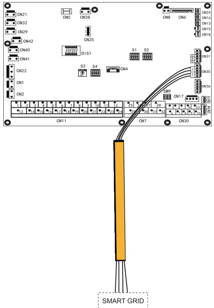
1. Quando il segnale EVU è attivo e il segnale SG è attivo, a condizione che la modalità ACS sia impostata in modo valido, la pompa di calore funzionerà in modo prioritario in modalità ACS e la temperatura di impostazione della modalità ACS passerà a 70°C. Se  $T5 < 69^\circ\text{C}$ , la TBH è attiva,  $T5 \geq 70^\circ\text{C}$ , la TBH non è attiva.
