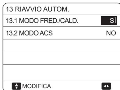
La funzione RIAVVIO AUTOM. riapplica le impostazioni dell'interfaccia utente al momento dell'interruzione dell'alimentazione. Se questa funzione è disabilitata, quando torna la corrente dopo un'interruzione dell'alimentazione, l'unità non si riavvia automaticamente.
