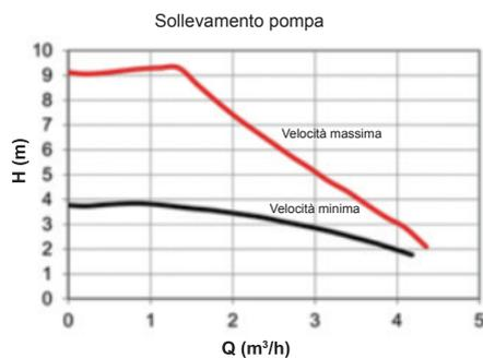
L'area di regolazione è compresa fra la curva di velocità massima e la curva di velocità minima.
