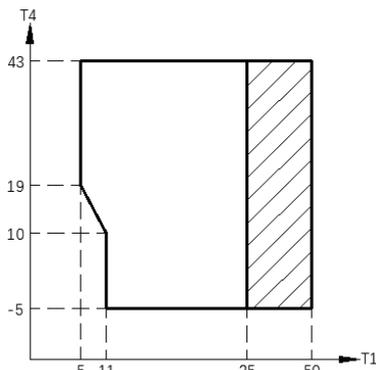
Range di funzionamento mediante pompa di calore con possibile limitazione e protezione.
