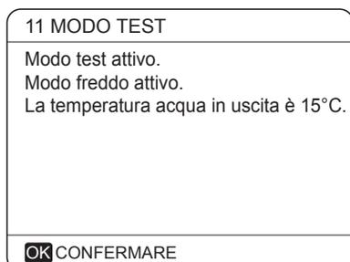
Durante il funzionamento del test MODO FREDDO, la temperatura predefinita dell'acqua in uscita è di 7°C. L'unità funzionerà fino a quando la temperatura dell'acqua non scenderà ad un certo valore o non verrà ricevuto il comando successivo.
