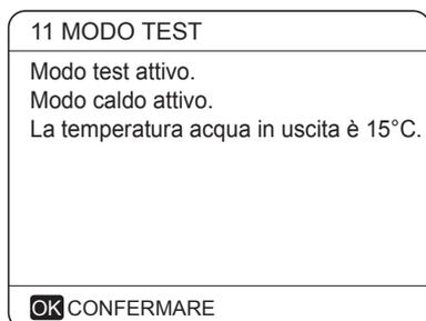
Durante l'esecuzione del test MODO CALDO, la temperatura predefinita dell'acqua in uscita è di 35°C. L'IBH (riscaldamento di backup interno) si accende dopo che il compressore funziona per 10 minuti. Dopo 3 minuti di funzionamento dell'IBH, l'IBH si spegne, la pompa di calore funziona fino a quando la temperatura dell'acqua non aumenta fino a un certo valore o fino a quando non si riceve il comando successivo.
