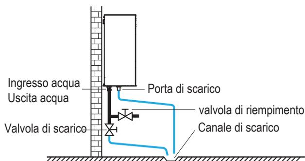
Quando l'acqua è ferma all'interno dell'impianto, è molto probabile che si verifichi un congelamento che danneggia l'impianto nel processo.
