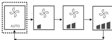
Fig. 28 - A sequência de 3 velocidades da ventoinha
