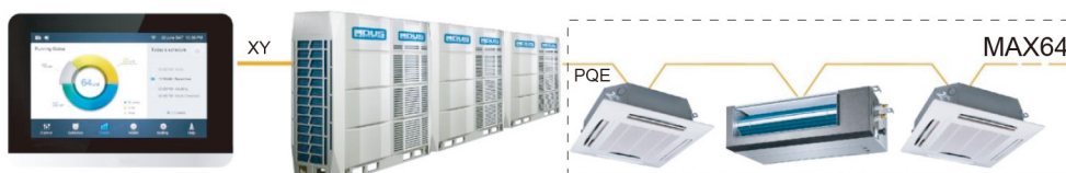
SI.-1(a) Vezalna shema od krmilnika do enojne zunanje enote
