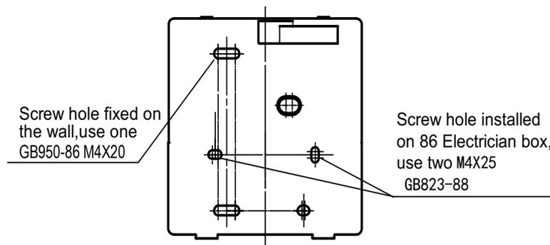
4) Ajustar o comprimento das duas barras de parafuso de plástico no acessório para ser o comprimento padrão da barra de parafuso da caixa elétrica para a parede. Certificar-se de quando instalar a barra de rosca na barra de parafusos da caixa elétrica, deixe-a tão plana quanto a parede.
