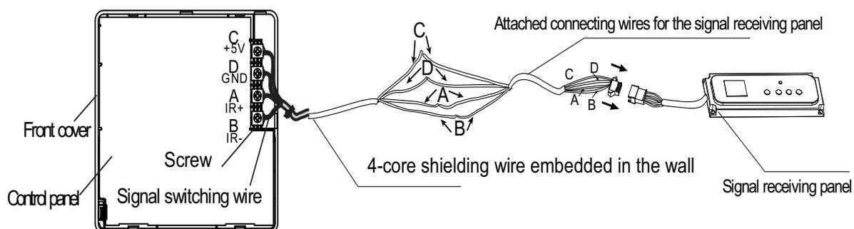
2) Se o fio de blindagem de 4 núcleos embutido não puder passar pelo controlador com fio, pode usar a comutação de sinal para conexão e garantir que os fios sejam confiáveis e firmes. A faixa de torque de aperto do parafuso é de 0,8 a 1,2 Nm (8 a 12 kgf.cm).
