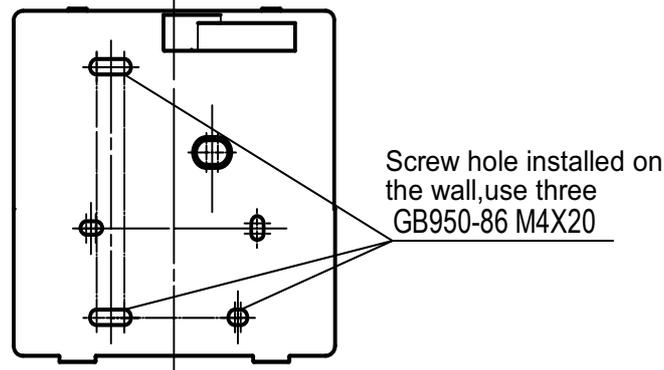
3) Usar dois parafusos M4X25 GB823-88 para instalar a tampa traseira na caixa do eletrícista 86 e usar um parafuso GB950-86 M4X20 para fixar à parede.
