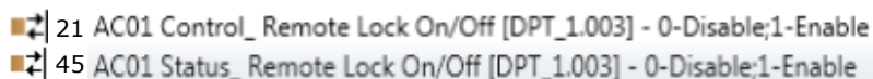
Schéma 4.24 Objets de communication affichés en rapport avec les objets de verrouillage à distance
