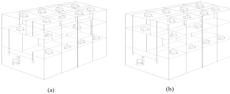
(a) Diagrama de cableado con buen efecto de comunicación (recomendado)
