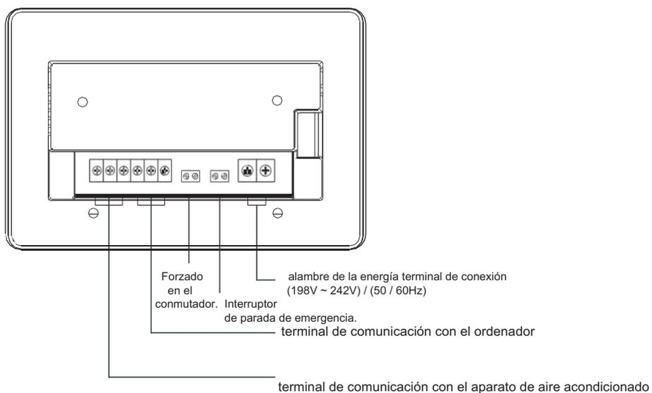
Fig.1.3 Terminal de controlador centralizado
