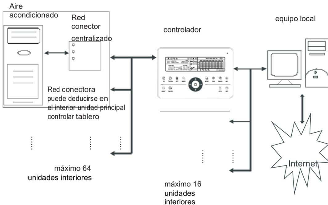
Fig.2.1 Aire red acondicionador diagrama de estructura de sistema de control
