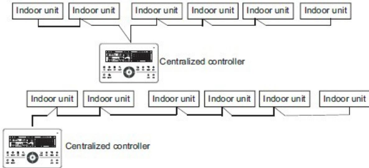
Fig.1.5 Diagrama de cableado del control centralizado y de la unidad interior del aire acondicionado
