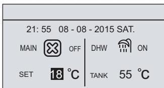
En réglant WATER FLOW TEMP. sur YES, et ROOM TEMP. sur YES, alors la température de l'eau sera affichée sur la page d'accueil. La température de l'eau et la température ambiante seront détectées et lorsque la température de l'eau ou la température ambiante atteignent la température cible, l'unité s'éteindra.
