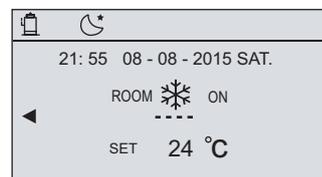
En réglant WATER FLOW TEMP. sur NON, et ROOM TEMP. sur YES, alors la température ambiante sera affichée sur la page d'accueil, et la température ambiante fonctionnera comme température cible. La température de l'eau de sortie cible peut être calculée à partir des courbes liées au climat.
