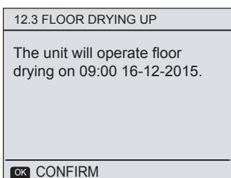
Au cours du séchage du sol, tous les boutons à l'exception de OK sont invalides. Lorsque la pompe à chaleur ne fonctionne pas correctement, le mode de séchage du sol s'éteint quand le chauffage de secours et la source de chauffage supplémentaire sont indisponibles. Si vous souhaitez désactiver le séchage du sol, appuyer sur OK. La page suivante apparaît :
